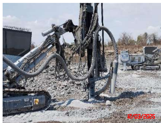
รูปที่ 24 เครื่องเจาะรูระเบิดที่มีอุปกรณ์เก็บฝุ่นติดไว้กับหัวเจาะ
